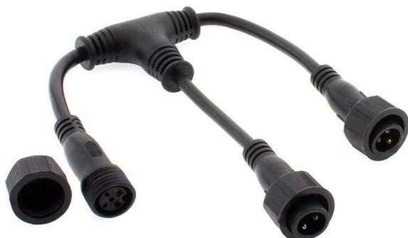
Cable DMX + alimentación. Dispone de conector hembra de 5 pines y dos cables con conectores macho, 1 con dos pines para alimentación y otro con 3 pines para conectar al cable XLR DMX. Especialmente diseñado para conexiones DMX de luminarias LED RGB
