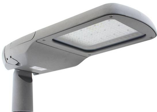
Farola de altas prestaciones LED chip Lumileds 130lm/w, con fijación horizontal, vertical y orientable, cuerpo de aluminio fundido a presión y vidrio templado con nuevo diseño para evitar la acumulación de polvo y aves. Equipo de alimentación electrónico IP-66 Clase I con protector de sobretensión 10 KV externo de driver. Apertura fácil para mantenimiento. Driver Meanwell.
