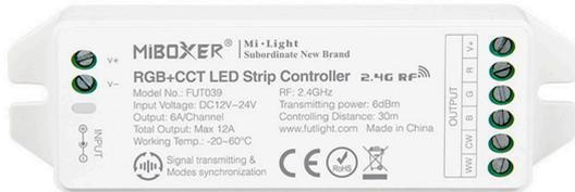
El nuevo controlador RGB+CCT de 4 zonas permite controlar hasta 4 zonas diferentes de tiras led RGB+CCT con una potencia de 12A (6A por canal). Con auto-transmisión entre los demás controladores con lo que se consiguen distancias sin límites y compatible con una amplia agama de mandos a distancia RF de mano, pared, APP, Wifi, Amazon Alexa y Google Assistant
