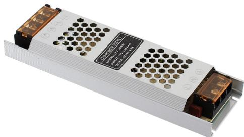
Fuente de alimentación con salida ajustable  $\pm 10\%$ , dimensiones reducidas con tan solo 2 cm de altura, refrigeración de la fuente por convección natural y protección contra sobrecargas y sobretensiones.
