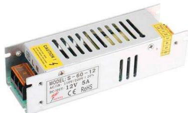
Fuente de alimentación conmutada con voltaje de entrada seleccionable 110-AC ó 230V-AC, voltaje de salida ajustable  $\pm 10\%$ , dimensiones reducidas, refrigeración de la fuente por convección natural y protección contra sobrecargas y sobretensiones.
