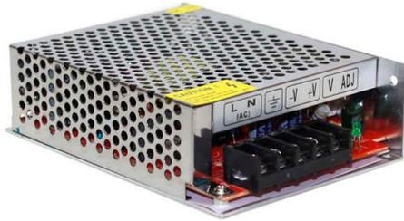
Fuente Alimentación Universal para uso en instalaciones interiores que proporciona una salida de DC24V/120W/5A. Para un uso de cargas permanentes de hasta 100W (80% de la carga total soportada). Capaz de aguantar picos de 120W.
