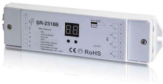
LED DRIVER de Corriente Constante (CC) con control DALI. Con 1 señal DALI para 4 canales sincronizados - 4x(8,4-25,2)W. Puede funcionar con pulsador externo para regular la intensidad sin necesidad de control DALI.
