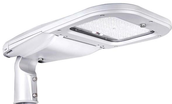
Farola de altas prestaciones, con LED chip OSRAM 125lm/w, con fijación horizontal, vertical y orientable, cuerpo de aluminio fundido a presión y vidrio templado con nuevo diseño para evitar la acumulación de polvo y aves. Equipo de alimentación electrónico IP-66 Clase I con protector de sobretensión 10 KV externo de driver. Apertura fácil para mantenimiento. Driver Meanwell o Inventronics (programable). Garantía de 5 años
