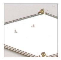
Instala los clips de sujeción de la fuente de alimentación
