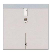
Instala sobre el techo los enganches en el que irán puestos los cordones de acero
