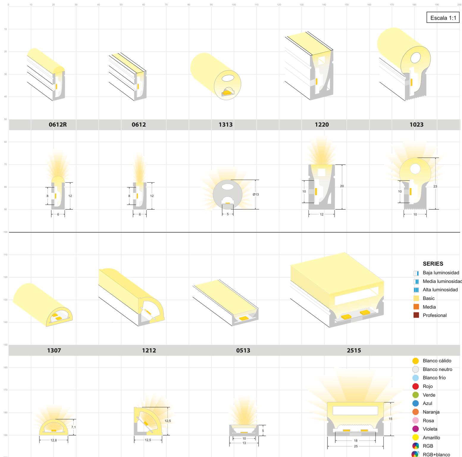
NEON LED de alta luminosidad en Tubo de silicona de máxima calidad y perfecta difusión de la luz. Con múltiples ventajas sobre los tradicionales NEON de PVC. Ideal para decoración, perfilar con luz, rotulación, interiorismo, etc. Los accesorios disponibles como grapas y perfiles de sujeción, tapas y clips de silicona específicos para cada modelo facilitan su instalación en cualquier proyecto.
